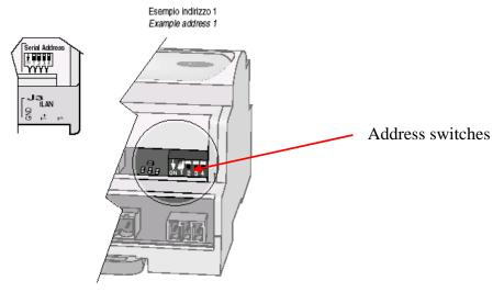
Fig.  $6 - pCO^{e}$  detail: switches
